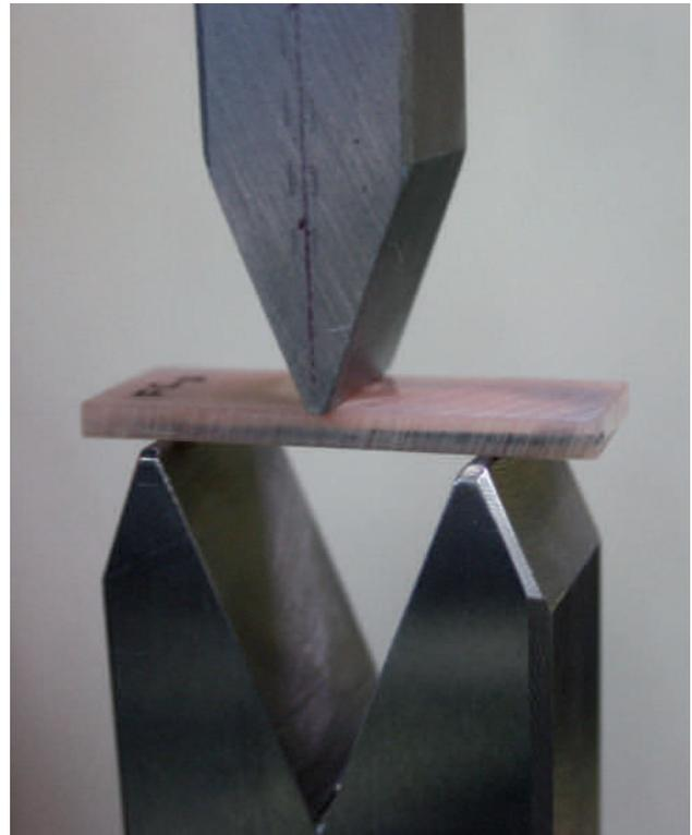
Figura 2. Empujador de la máquina de ensayos.
