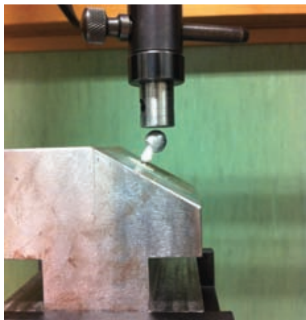
Figura 2. Montaje para ensayo de resistencia estática.
